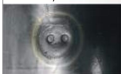
Heat Caulking метод на Mitsubishi Electric за топлинно уплътняване намалява деформацията на цилиндра и с това осигурява още по-висока енергийна ефективност.
